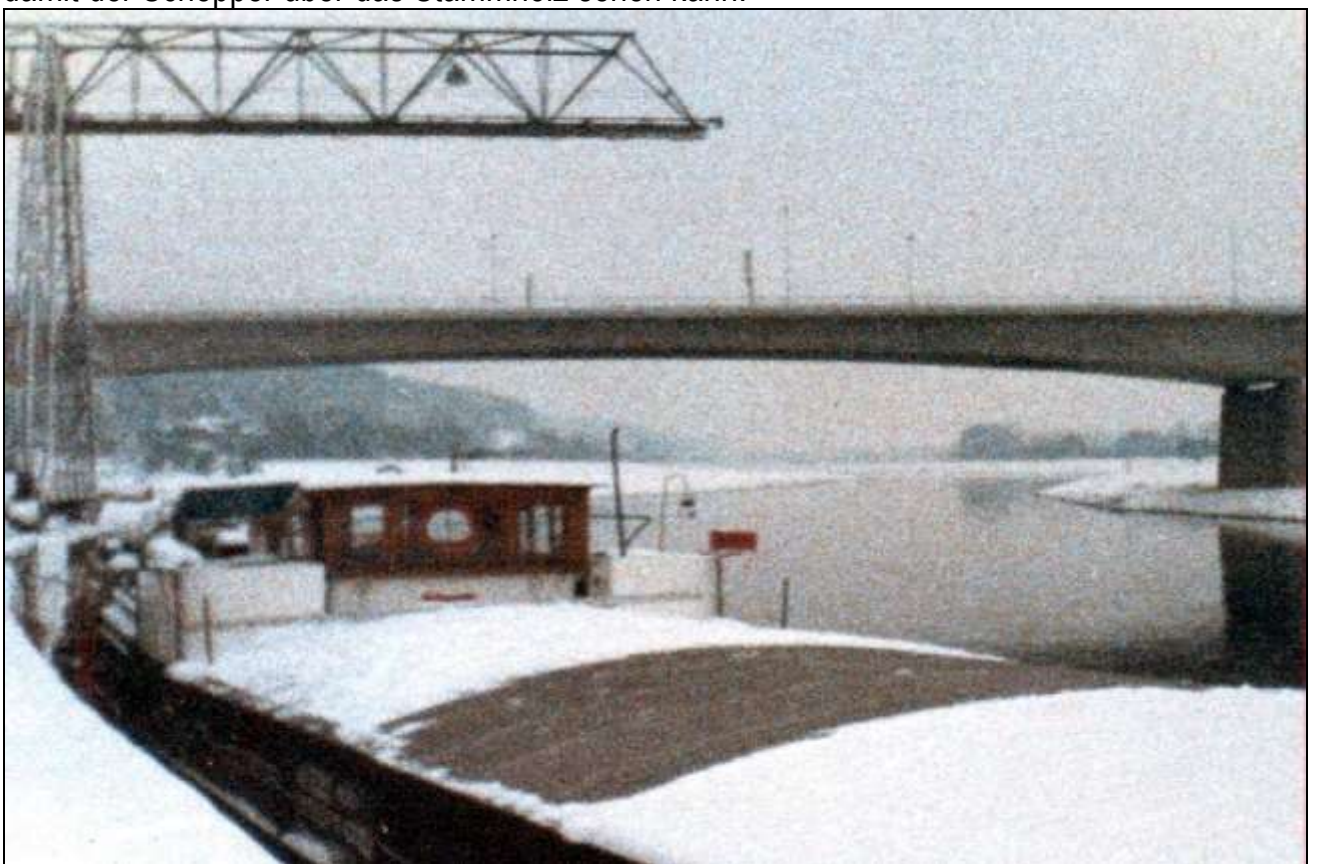
(1985) Vlotho - Bevor man die Luken aufdecken kann, muss erst Schnee gefegt werden - sonst sind sie zu schwer. Das Steuerhaus ist wegen der Kälte heruntergefahren.
