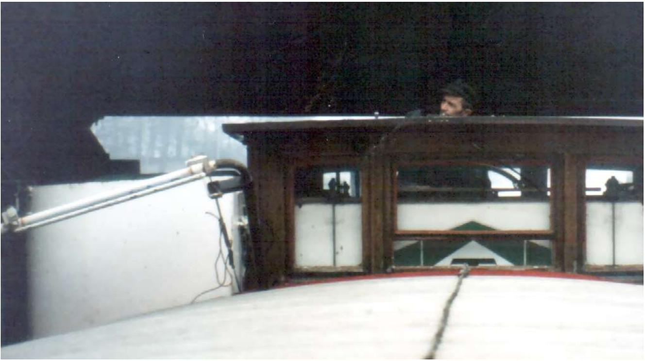
Bild oben: (1987) - „Hein duuk di“. Das Oberteil des Steuerhauses (die Scheiben) ist heruntergefahren. Der Schepper muss auf seinen Kopf aufpassen.
